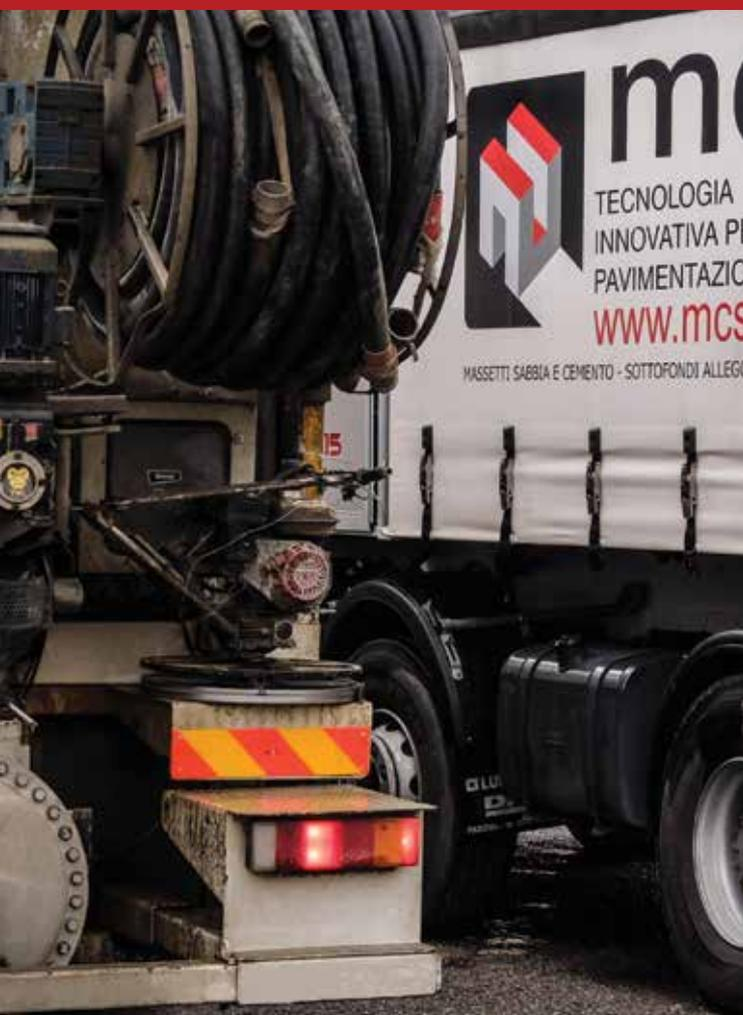
Non è necessario alcun supporto cantieristico, se non un normale attacco alla rete idrica. I nostri automezzi hanno una completa autonomia di materiali caricati per la realizzazione di circa 250 m<sup>2</sup> di massetto con spessore medio di 6 cm, senza la necessità di ricariche in cantiere, in pieno rispetto dell'ambiente grazie all'utilizzo di motrici euro 5/6 e ad impianti esenti da fumi e particelle nocive.
